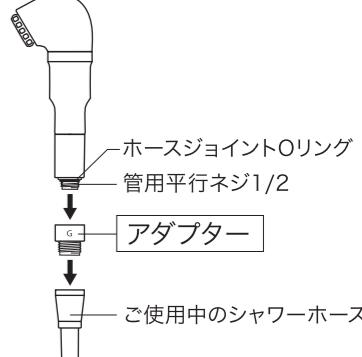
●シャワーへッドにアダプターを取付けてから、本品を取付けます。
